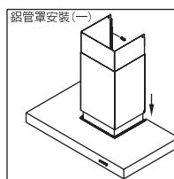
鋁管罩請依廚櫃設計調整高度固定後，再放至機身凹槽內(如圖二)。
