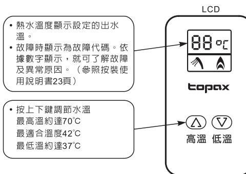
顯示屏顯示時能調節水溫。
