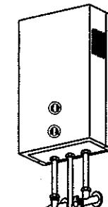
5. 燃氣入口之接頭與軟管接合時，請確實將軟管套入至接頭紅線處，並以管束束緊，以免燃氣洩漏。
