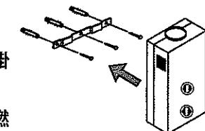
2. 取下吊架，以钢钉将吊架钉牢于牆壁，将热水器挂上。（圖七）
