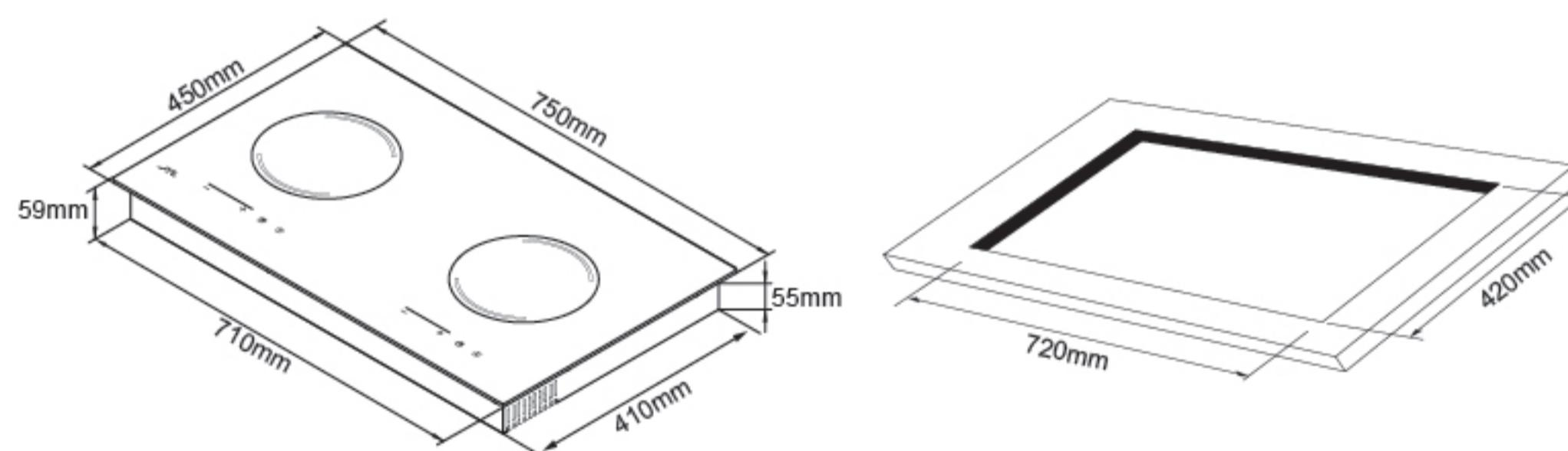
櫃體安裝孔中間請留隔板，隔板左右留兩孔至少100mm面積孔位(如下圖所示)，孔位為熱氣循環用，可任意形狀。
