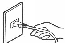
請勿用力拉扯電線將電源插頭拔除，
