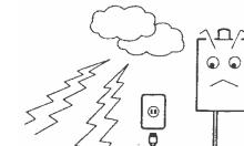
因由雷電產生之瞬間高電壓會損傷電子零件，雷電產生時，請迅速將電源插頭從插座上拔除。
