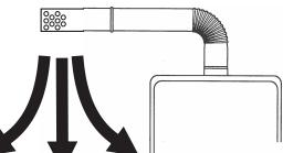
安裝時請勿將廢氣直接排放向熱水器入風口方向，以防燃燒時氧氣不足。
