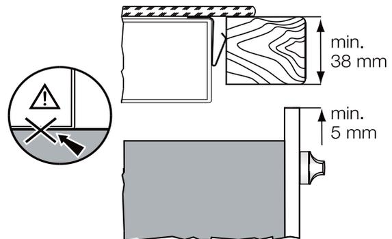
⚠ 警告！底座的表面溫度會超過 $95^{\circ}\text{C}$ 。因此底部必須在安裝時加裝不可燃的擋板，以免意外接觸到高溫區域。
